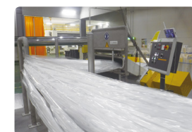
フィルムロスを粉砕機で粉砕し再度溶融して原料化
