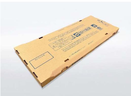
環境と荷役に配慮したオール段ボール製の店舗用エアコン室外機用天トレイです。従来天トレイに使用していた発泡スチロールと合板を廃止し、オール段ボール化するとともに、輸送に必要なPPバンドの食い込みや破れ防止を構造的に備えた天トレイを実現しました。糊貼りやワイヤ止めが不要で一枚の段ボールシートのみで組み立てられる仕様です。
