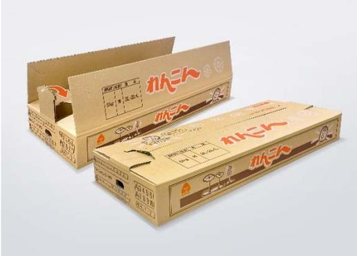
テープやステープルを使用せず、片手で封かんでできる段ボールケースです。内フラップの押し込み部分を外フラップに差し込むだけで簡単に封かんすることができます。押し込み部分が箱の中の製品に直接触れず、製品を傷つけることもなく、再封かんも可能です。作業者の負担軽減に貢献します。
