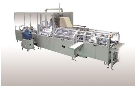
内容品に合わせて高さを自在に変えられる ジェミニ・パッケージングシステム
