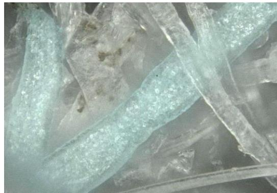
セルガイア配合梅炭抄織糸の実態顕微鏡写真
